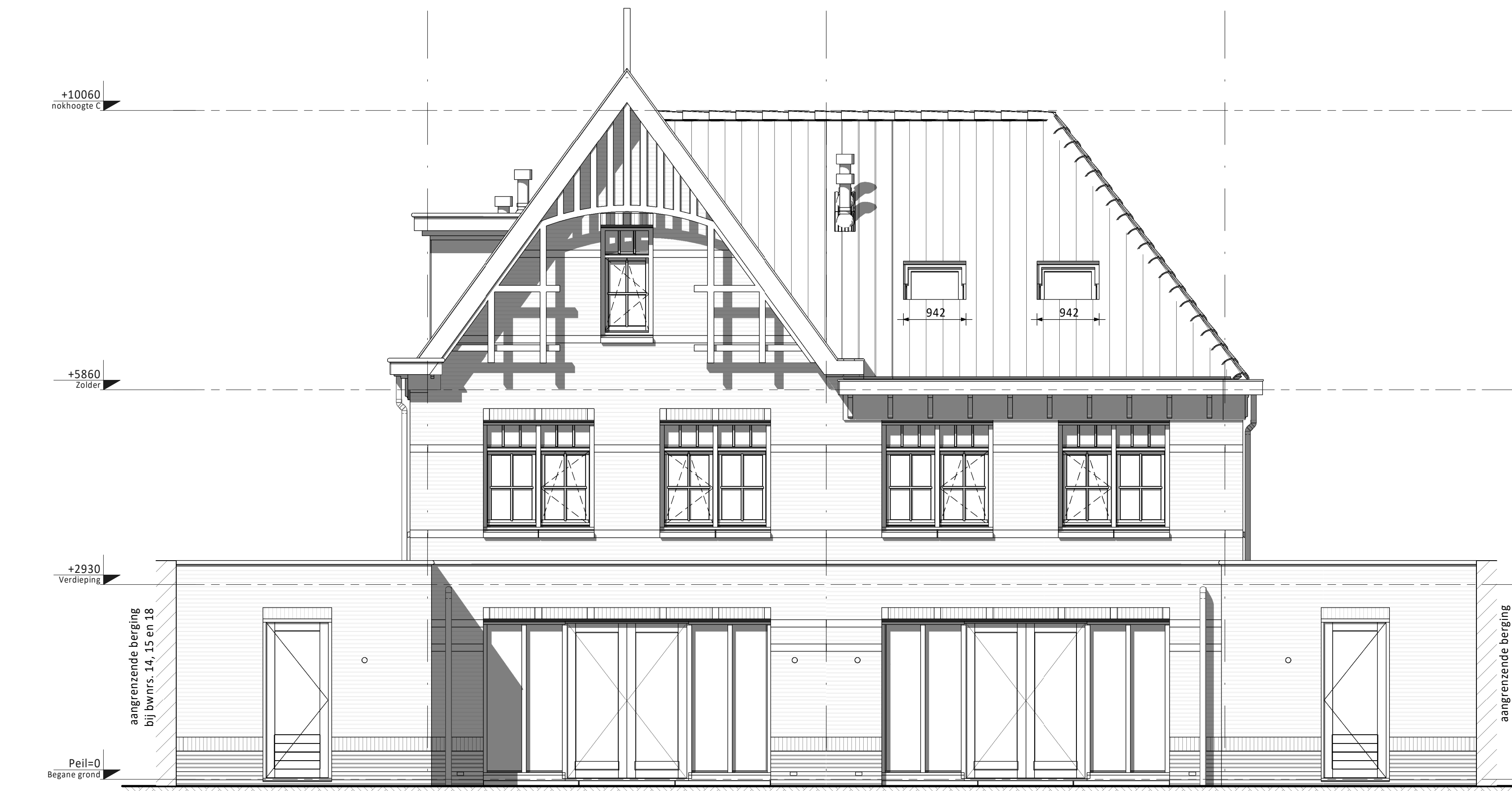
Achtergevel ③ Type D • Aanbouw 2,4m achtergevel (op de begane grond) • Brede gevelpui met dubbele openslaande deuren achtergevel ② Type C • Aanbouw 2,4m achtergevel (op de begane grond) • 2 dakramen achterzijde (afzonderlijk van elkaar te kiezen) • Brede gevelpui met dubbele openslaande deuren achtergevel ①
