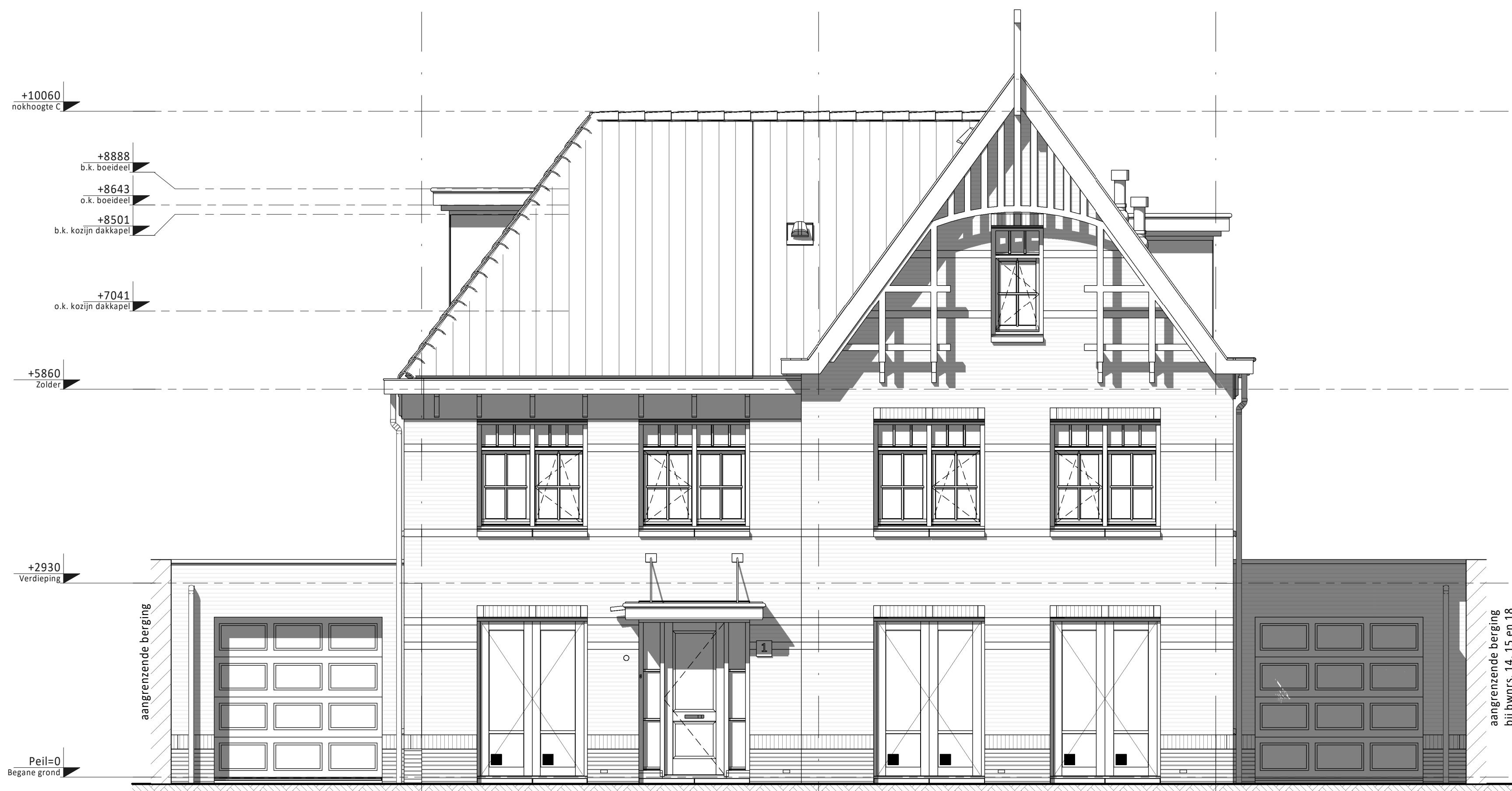
Voorgevel ① Type C • Dubbele openslaande deuren voorgevel • Dakkapel kopgevel (niet mogelijk i.c.m. alternatieve indeling zolder) ② Type D • Basis woning ③
