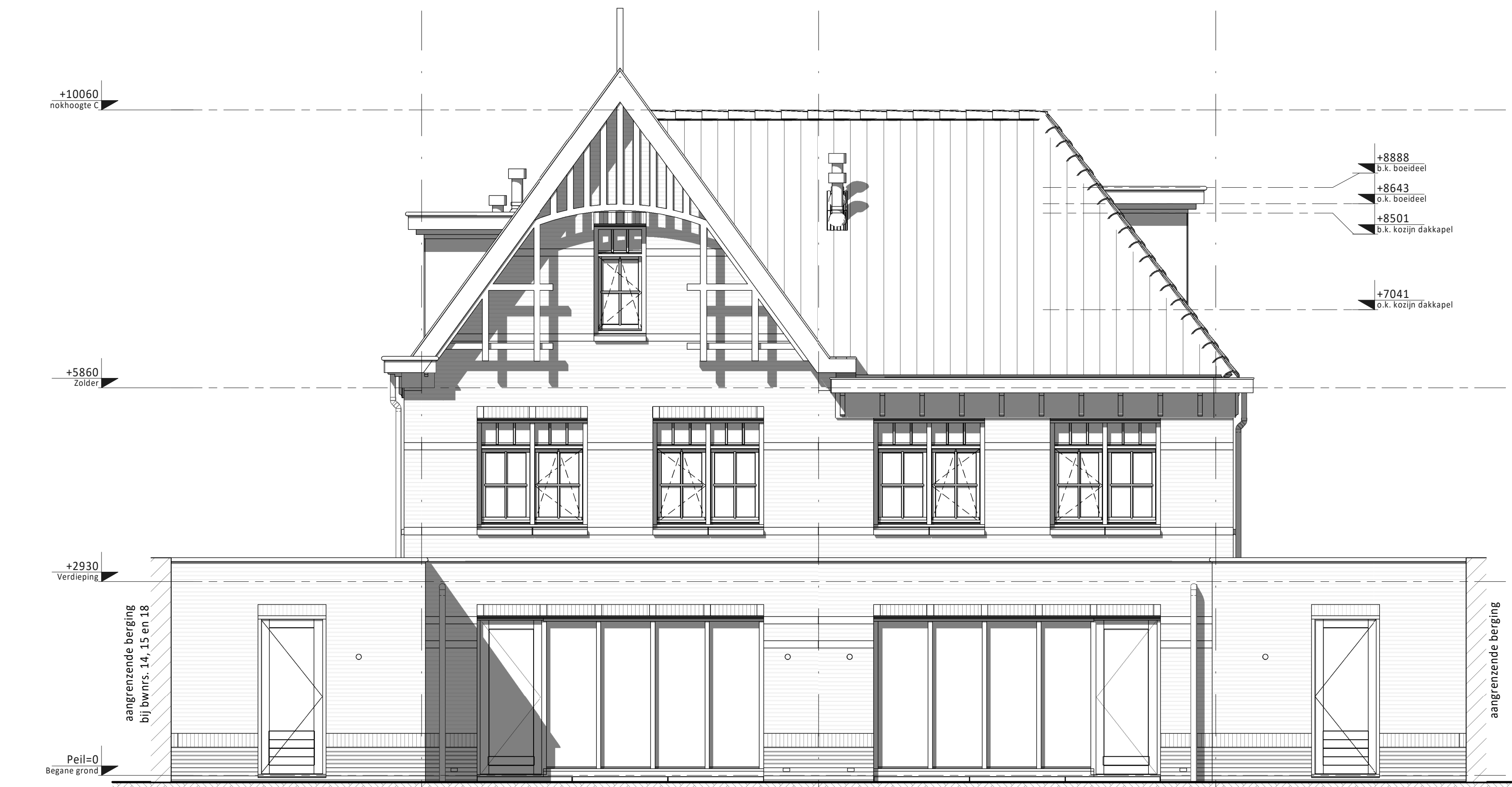
Achtergevel ③ Type D • Brede gevelpui achtergevel • Aanbouw 1,8m achtergevel (op de begane grond) ② Type C • Brede gevelpui achtergevel • Aanbouw 1,8m achtergevel (op de begane grond) • Dakkapel kopgevel (niet mogelijk i.c.m. alternatieve indeling zolder) ①
